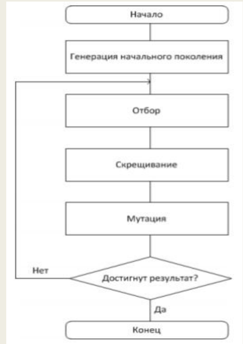
Рисунок 4 – Блок-схема работы генетического алгоритма.
