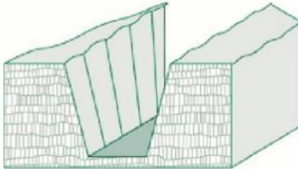
Траншеи без укрепления стенок
