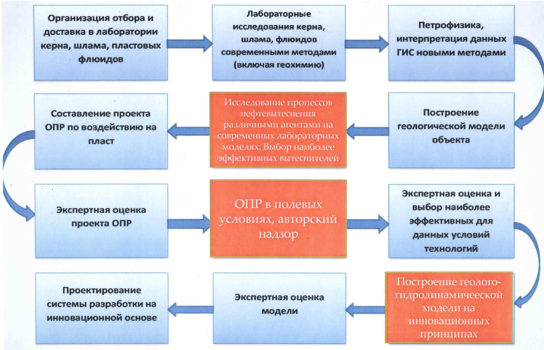
Схема организации подготовки исходных данных для инновационного проектирования разработки нефтяных месторождений
