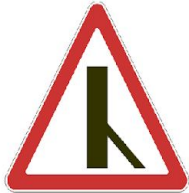
2.3.6 Примыкание второстепенной дороги
