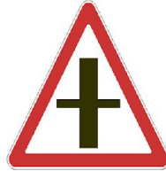
2.3.1 Пересечение с второстепенной дорогой
