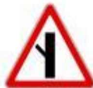
2.3.4 Примыкание второстепенной дороги
