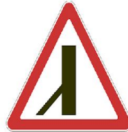
2.3.6 Примыкание второстепенной дороги
