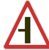
2.3.3 Примыкание второстепенной дороги
