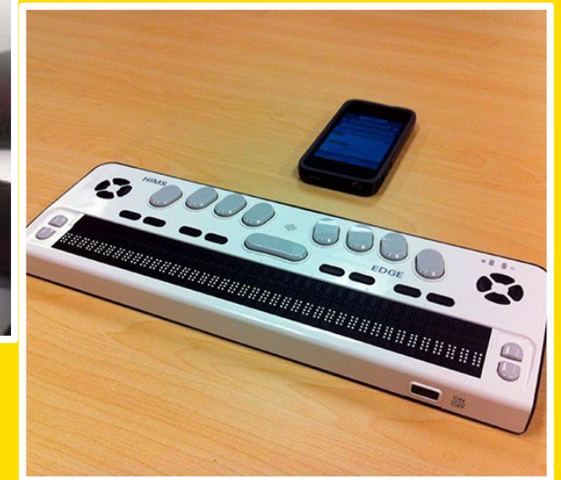
Дисплей Брайля – это электронное устройство для отображения и набора текстов рельефно-точечным шрифтом.
