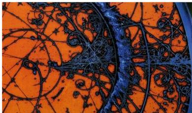
Фотография столкновения элементарных частиц в главной пузырьковой камере ускорителя Европейского центра ядерных исследований (ЦЕРН) в Женеве, Швейцария. **Траектории движения элементарных частиц расцвечены для большей ясности картины. Голубыми линиями отмечены следы пузырьков, образующихся вокруг атомов, возбужденных в результате пролета быстрых заряженных частиц.**
