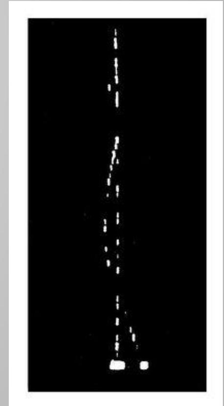
Трек частицы в узкоззорной искровой камере
