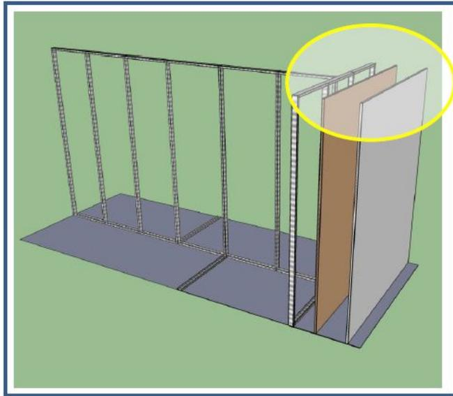
Стена монтируется из двух слоев разных материалов - (рис. А)
