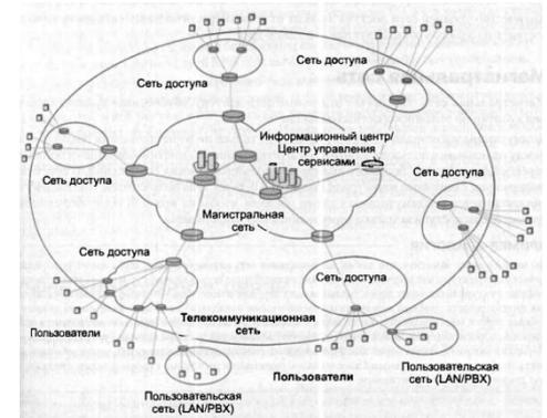
**Сеть доступа** составляет нижний уровень иерархии телекоммуникационной сети. Основное назначение сети доступа — концентрация информационных потоков, поступающих по многочисленным каналам связи от оборудования клиентов, в сравнительно небольшом количестве узлов магистральной сети.
