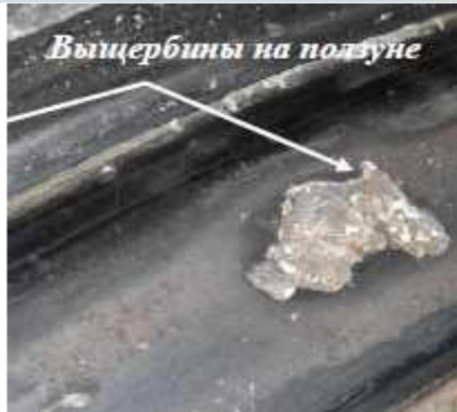
С выщербиной, раковиной или вмятиной на поверхности катания колесных пар глубиной - **более 3 мм** и длиной или шириной - **более 10 мм** (моторный вагон) и **25 мм** (прицепной вагон)
