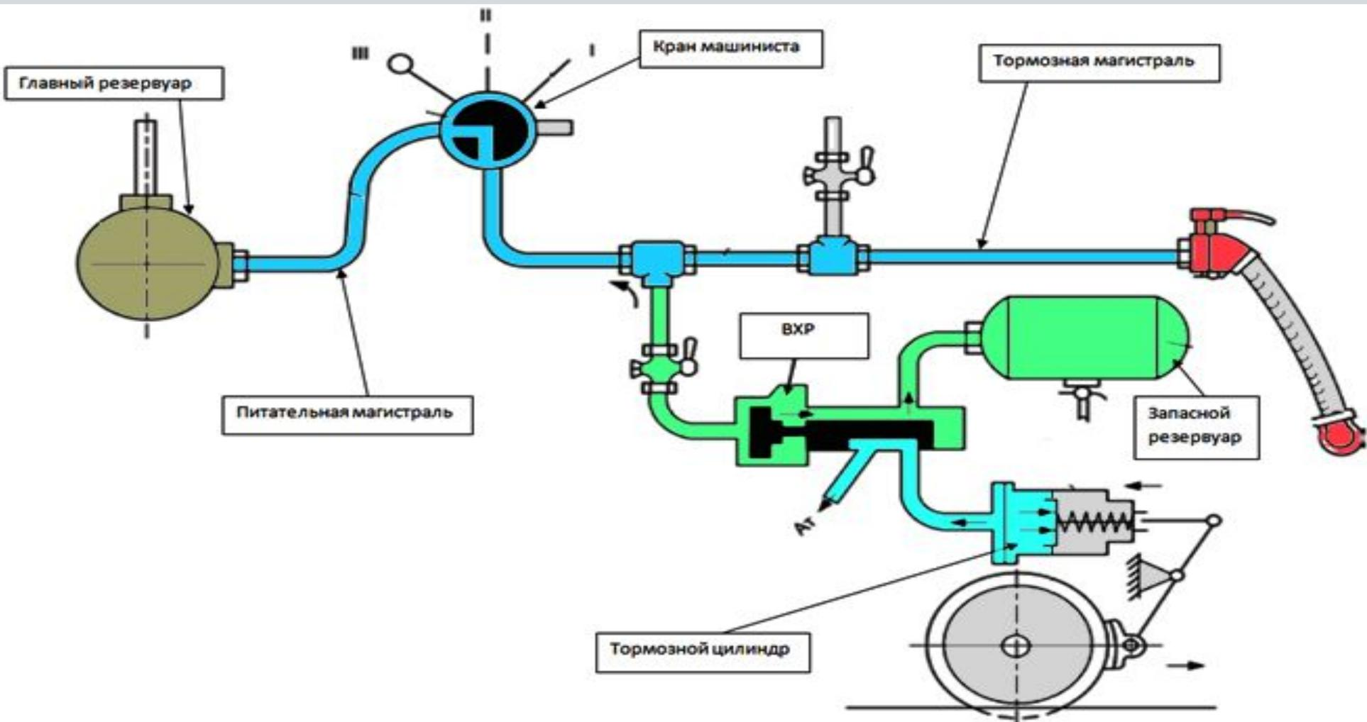
Автоматические тормоза должны обеспечивать - возможность применения различных режимов торможения в зависимости от загрузки вагонов, длины поезда и профиля пути (Прил.№5 п.16 ПТЭ)
