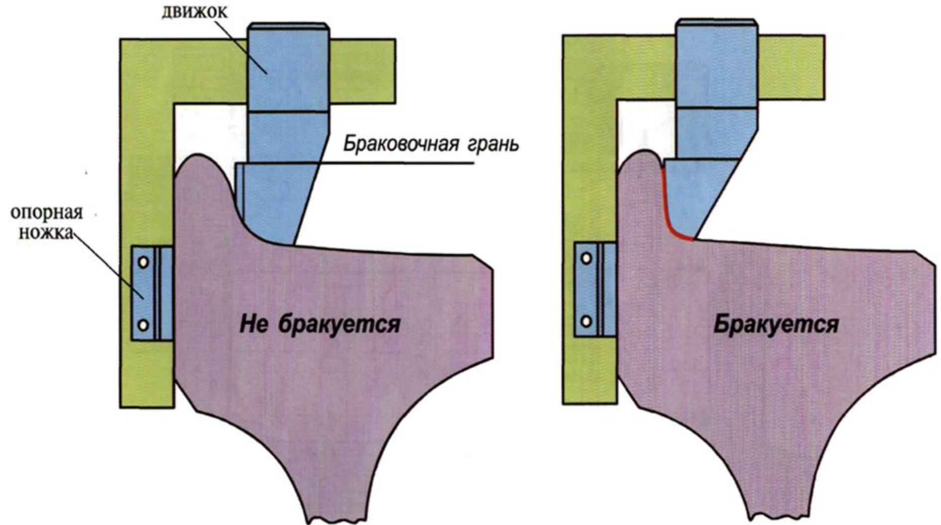
Вертикальный подрез гребня высотой более 18 мм, измеряемый специальным шаблоном (Прил.№5 п.14 ПТЭ)
