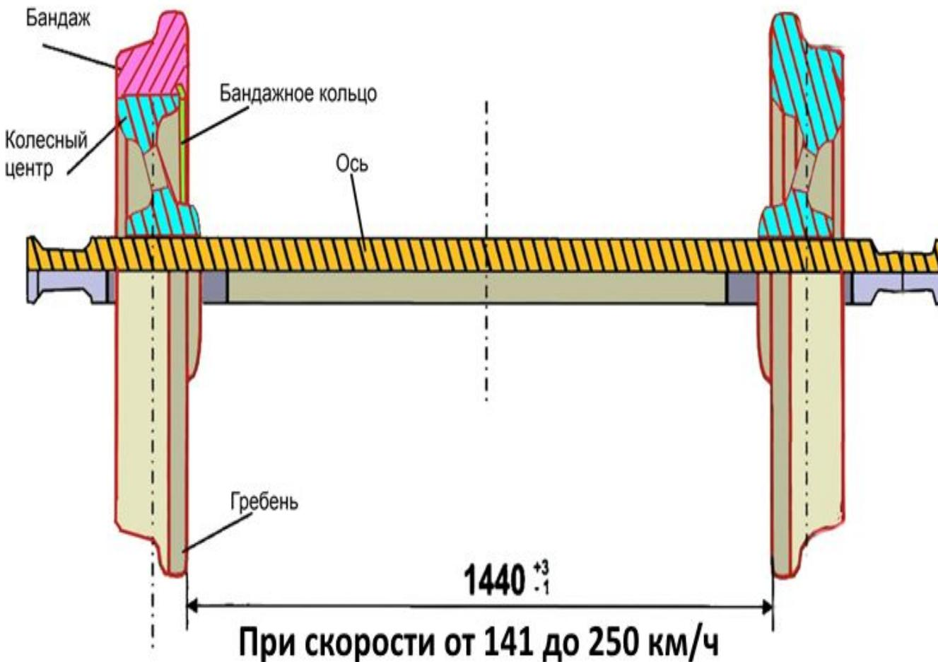
Расстояние между внутренними гранями колес у ненагруженной колесной пары должно быть - 1440 мм при скоростях до 120 км/ч отклонения допускаются в сторону увеличения и уменьшения не более 3 мм, при скоростях свыше 120 км/ч до 140 км/ч, отклонения допускаются в сторону увеличения не более 3 мм и в сторону уменьшения не более 1 мм
