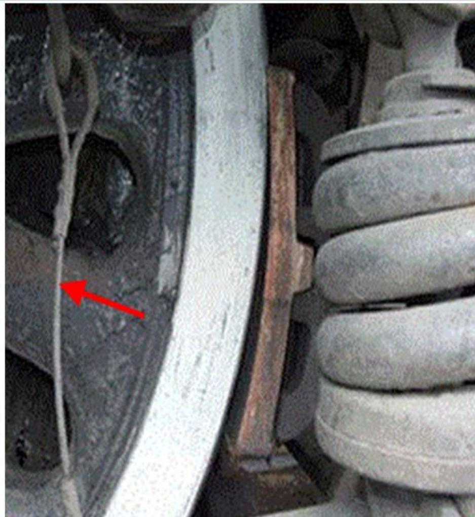
Все части рычажной тормозной передачи, разъединение или излом которых может вызвать выход из габарита или падение на путь, должны иметь - предохранительные устройства (Прил.№5 п.18 ПТЭ)
