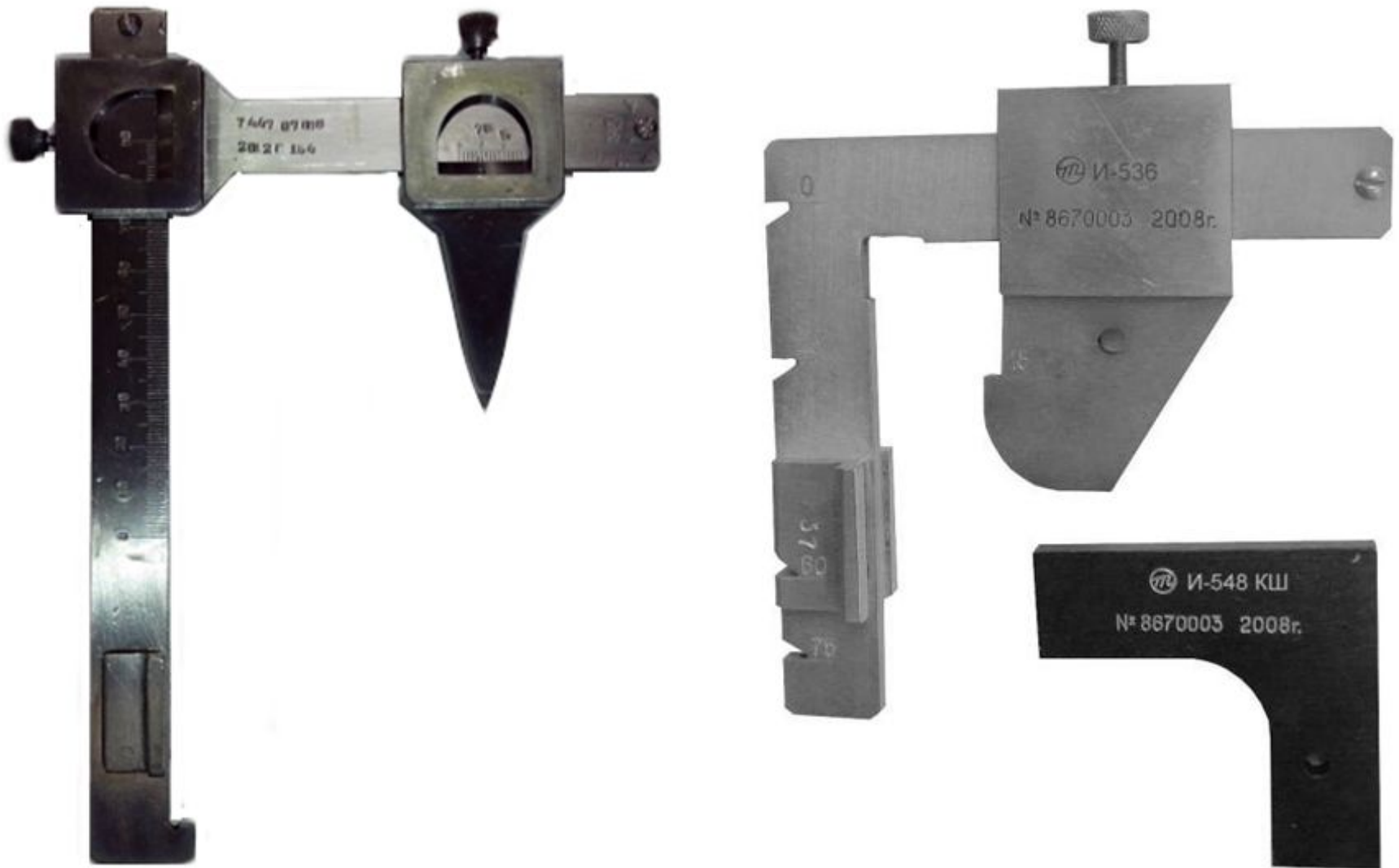
Толщиномер и контроля вертикального подреза гребня
