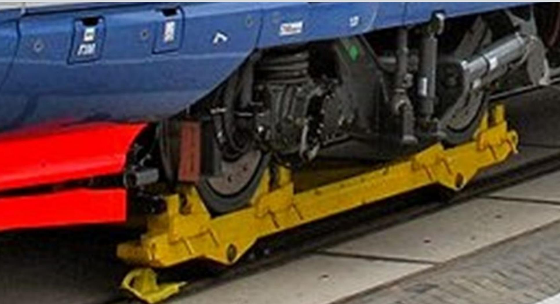
Для транспортировки МВПС до места обточка или замены колесных пар должны использоваться специальные транспортные тележки (Прил. №9 п.53)
