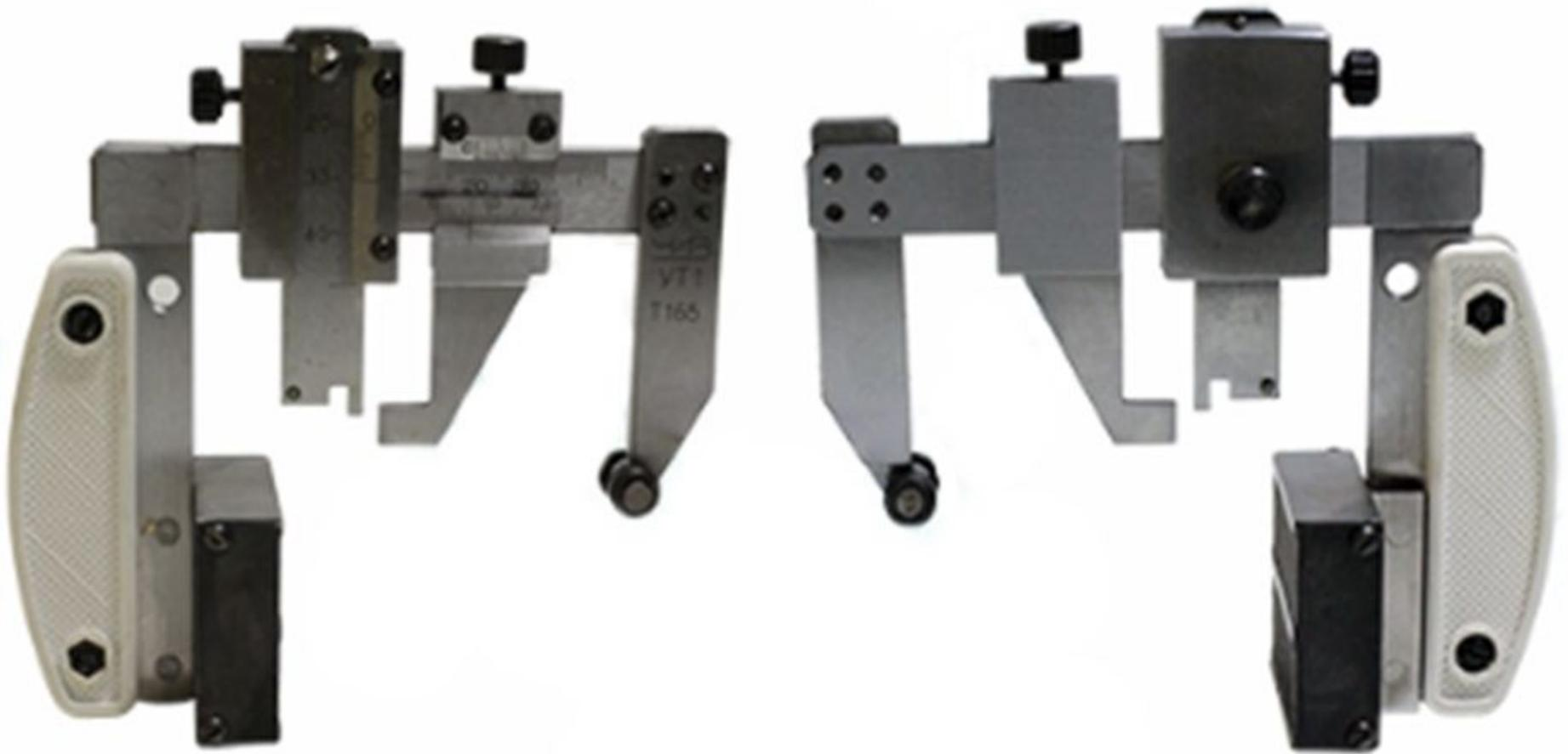
Универсальный шаблон УТ-1М (тяговый) - предназначен для контроля геометрических параметров поверхности катания бандажей колесных пар тягового подвижного состава: **толщины и высоты гребня, и его параметра крутизны**
