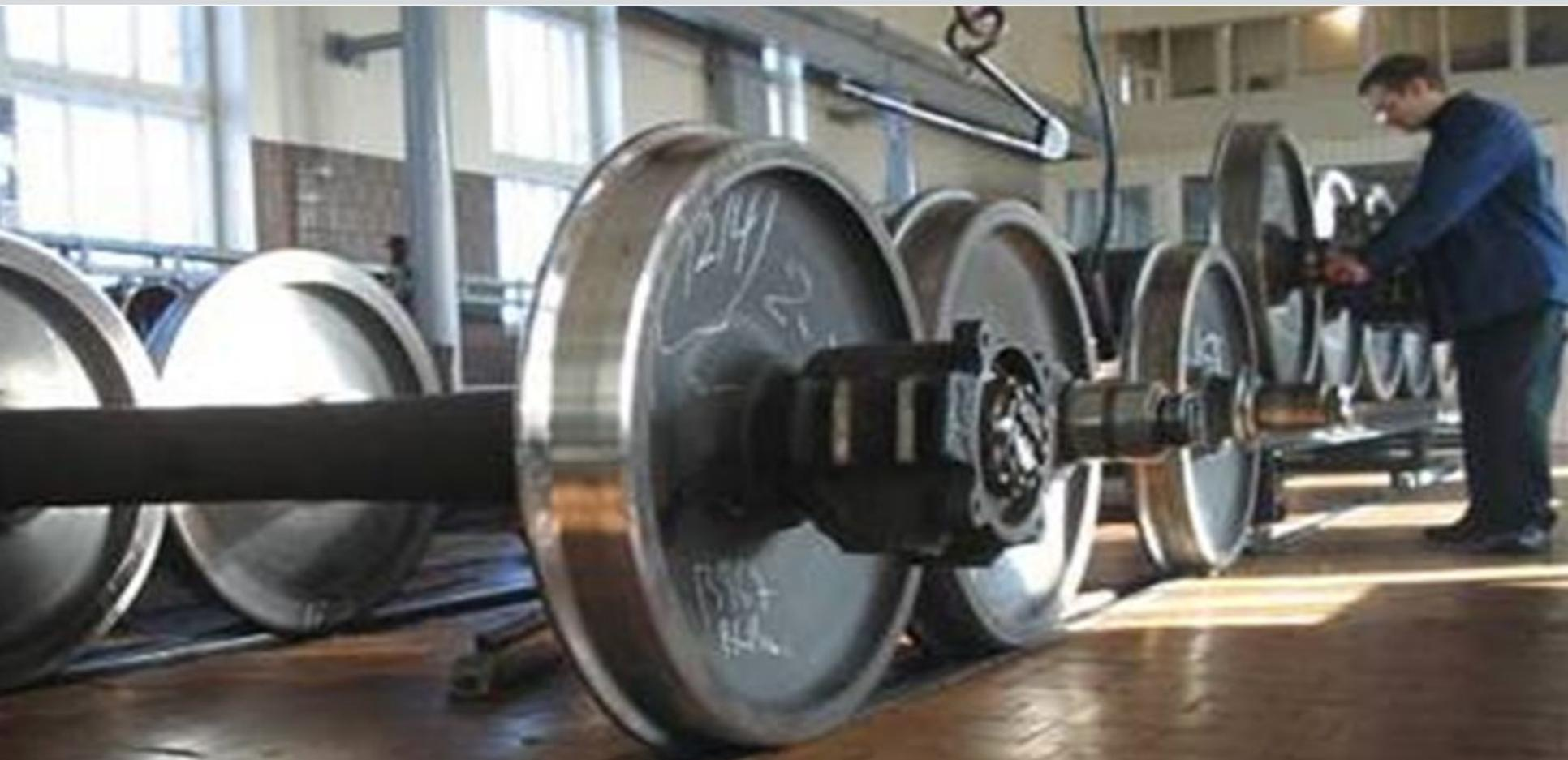
Колесные пары должны подвергаться – техническому обслуживанию (осмотру) под подвижным составом, текущему ремонту (обыкновенному освидетельствованию), среднему ремонту (полное освидетельствование) и капитальный ремонт (ремонт со сменой элементов).
