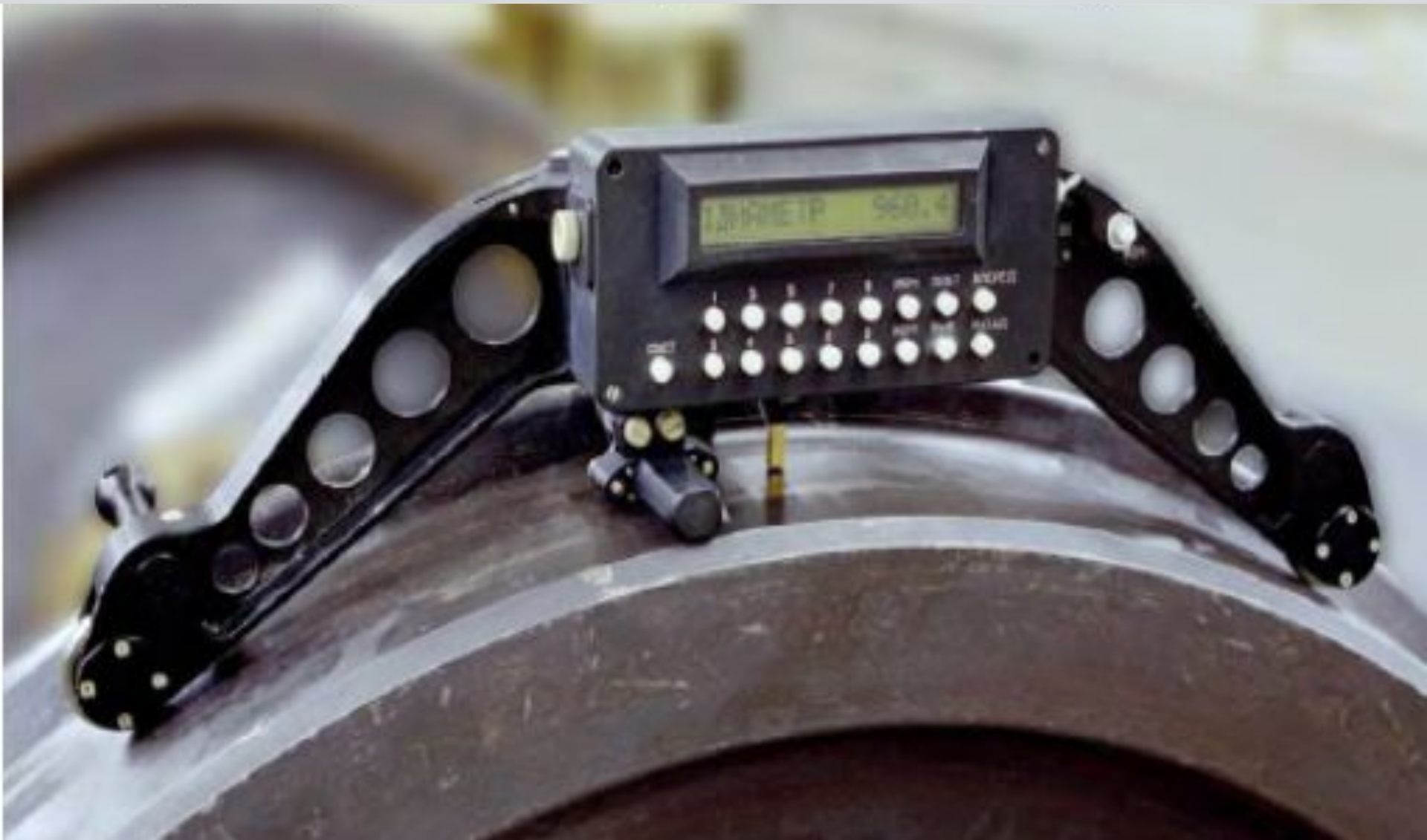
Прибор для измерения диаметра колесных пар
