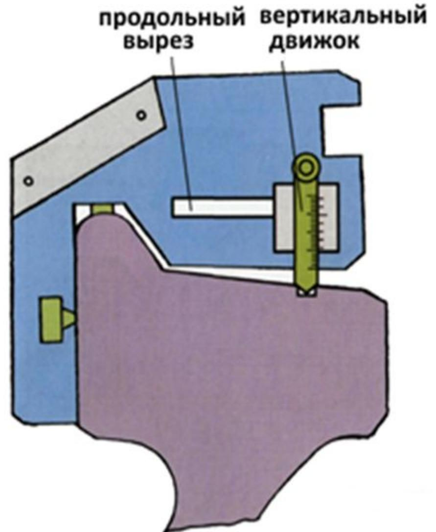
С кольцевой выработкой на поверхности катания колесной пары
