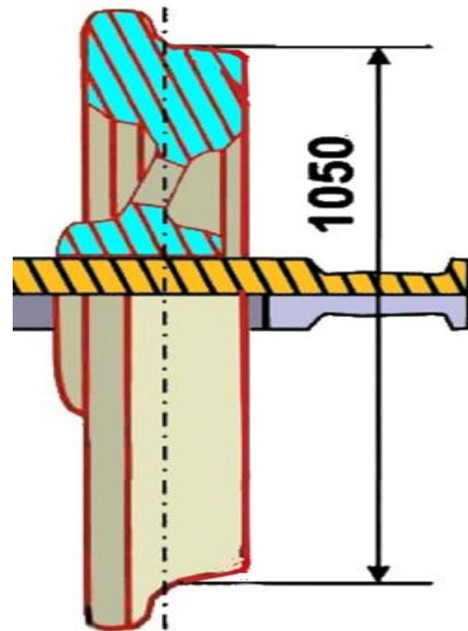
При скоростях свыше 140 до 160 км/ч - с разницей диаметров бандажей колес по кругу катания одной колесной пары при обточке ее с выкаткой и без выкатки - **более 0,5 мм**;
