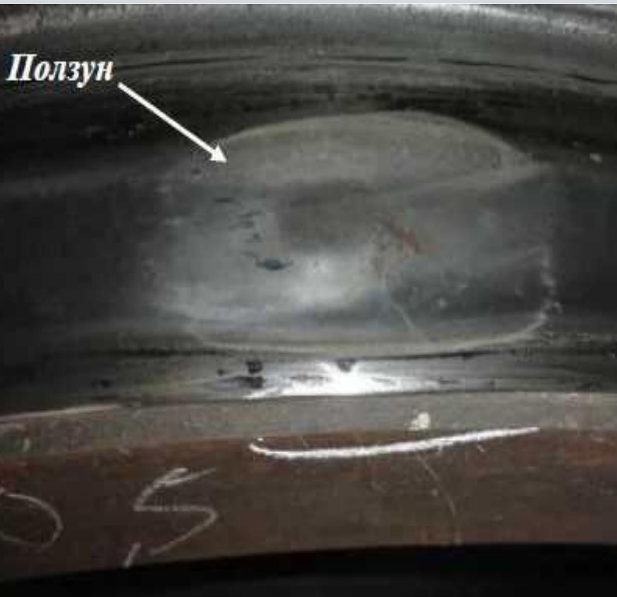
При наличии ползуна (выбоины) на поверхности катания при скорости движения до 120 у локомотивов, МВПС, ССПС, и вагонов с роликовыми буксовыми подшипниками глубиной - **более 1 мм**
