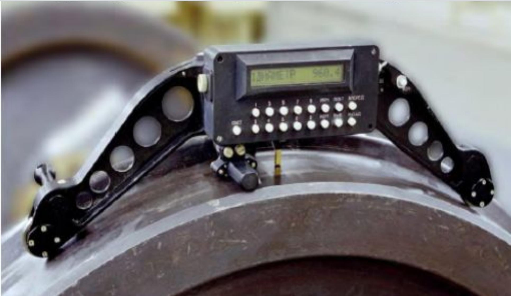
Прибор для измерения диаметра колесных пар
