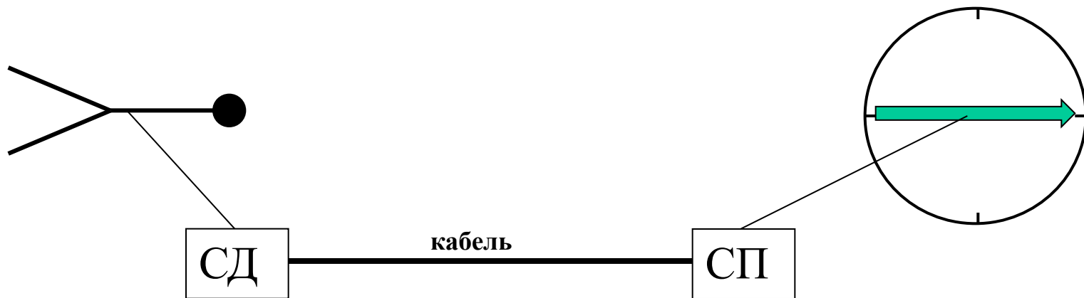
Рис. 3.6.3. Пояснение действия сельсинов.
