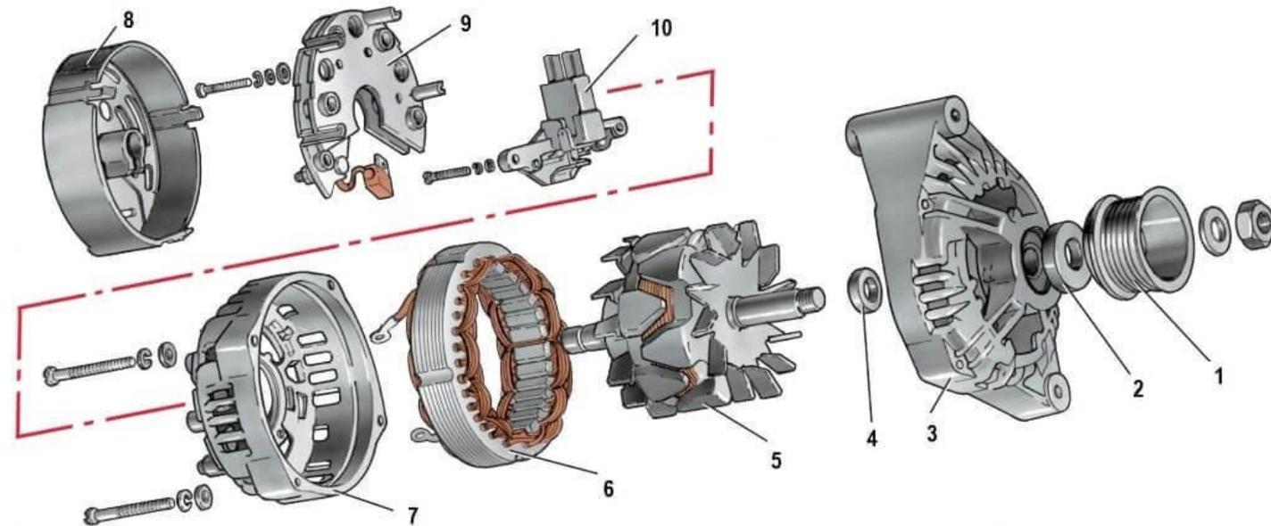
Детали генератора: 1 – шкив; 2 – шайба; 3 – передняя крышка; 4 – дистанционное кольцо; 5 – ротор; 6 – статор; 7 – задняя крышка; 8 – кожух; 9 – выпрямительный блок с конденсатором; 10 – щеткодержатель с регулятором напряжения
