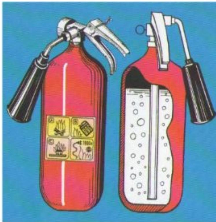
Предназначен для тушения твердых веществ, жидкостей и газов.
