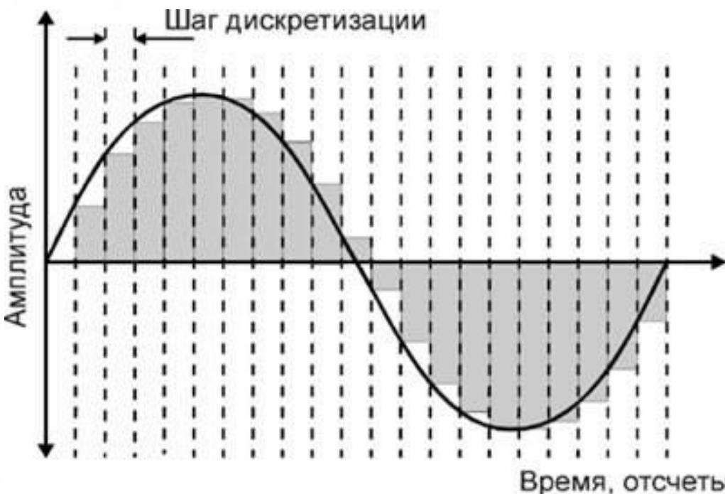
**Сэмплрэйт** (sample rate) - частота дискретизации (или частота сэмплирования) - частота взятия отсчетов непрерывного во времени сигнала при его дискретизации (в частности, аналого-цифровым преобразователем - АЦП),
