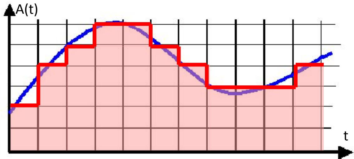
**КВАНТОВАНИЕ** - процесс замены реальных значений сигнала приближенными с определенной точностью.
