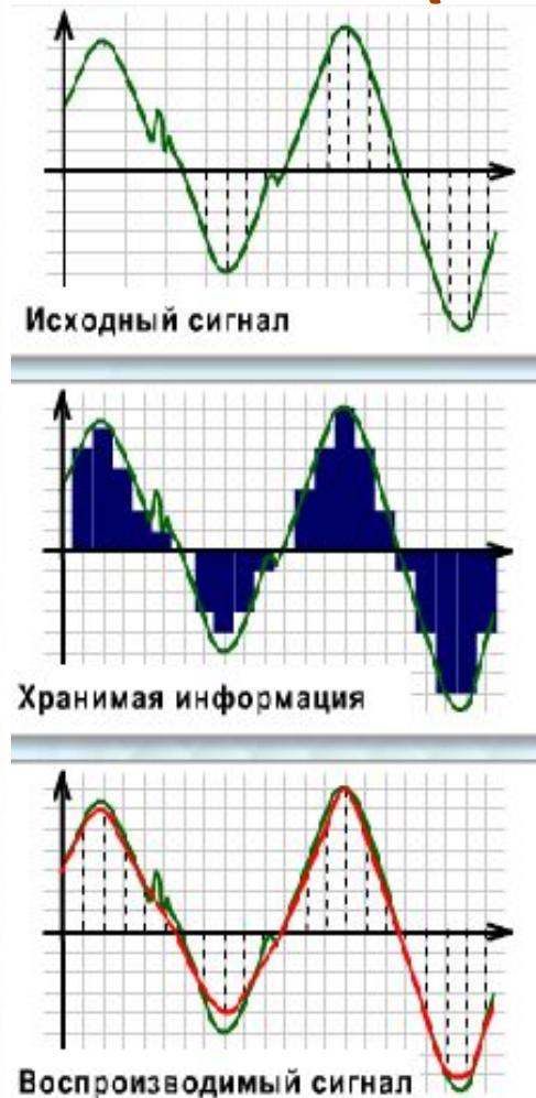
Звуковая информация хранится в виде значений амплитуды, взятых в определенные моменты времени (т. е. измерения проводятся «импульсами»).
