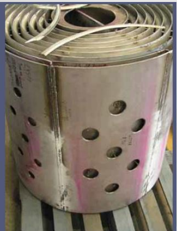
Спиральный теплообменник без кожуха
