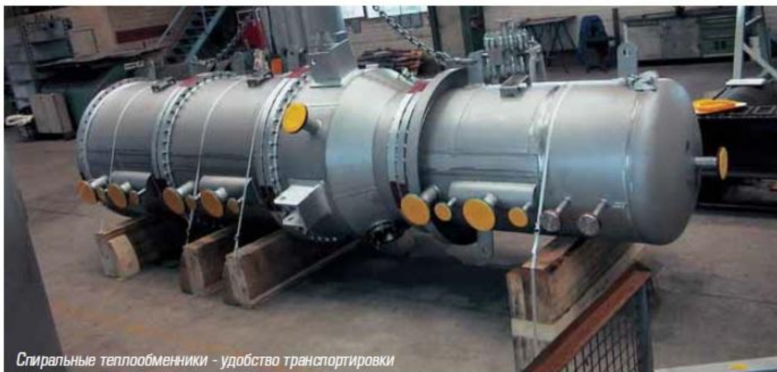
Спиральный теплообменник без кожуха
