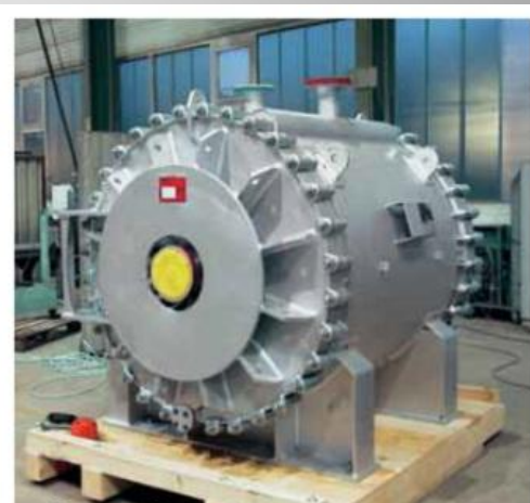
Спиральный теплообменник в сборе на поддоне
