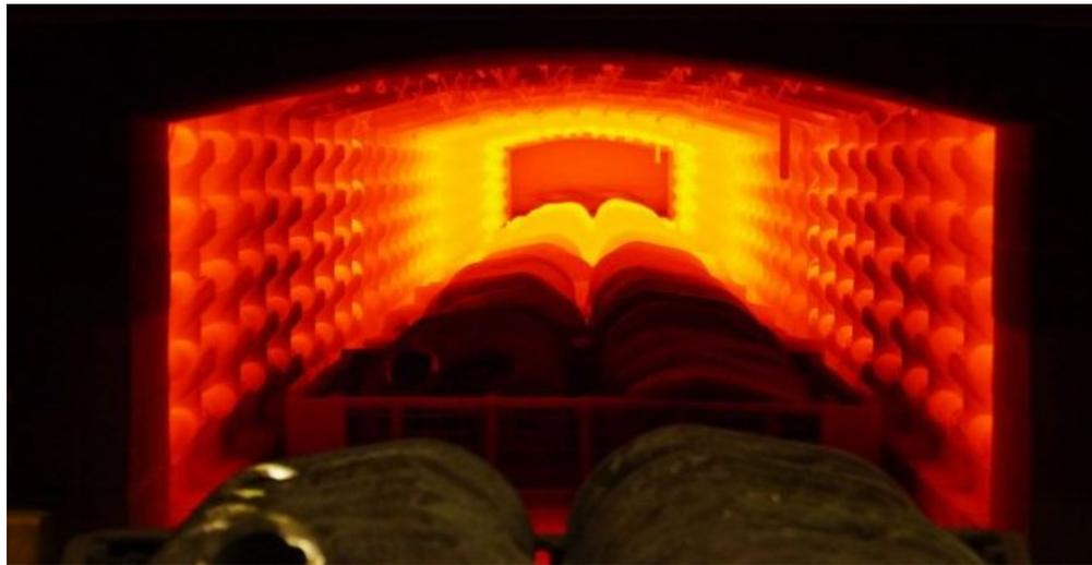
Закалка и последующий отпуск при высокой температуре называют **термическим улучшением.**
