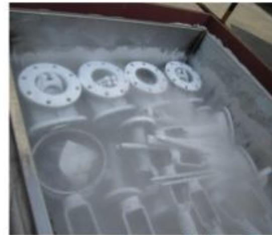
Охлаждающими жидкостями являются: жидкий воздух, азот, смесь твердой углекислоты с денатурированным спиртом.
