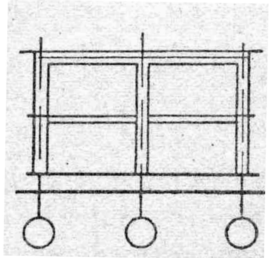
6. Изображаем другие элементы здания, расположенные за секущей плоскостью (крышу, перегородки, окна, двери и др.);
