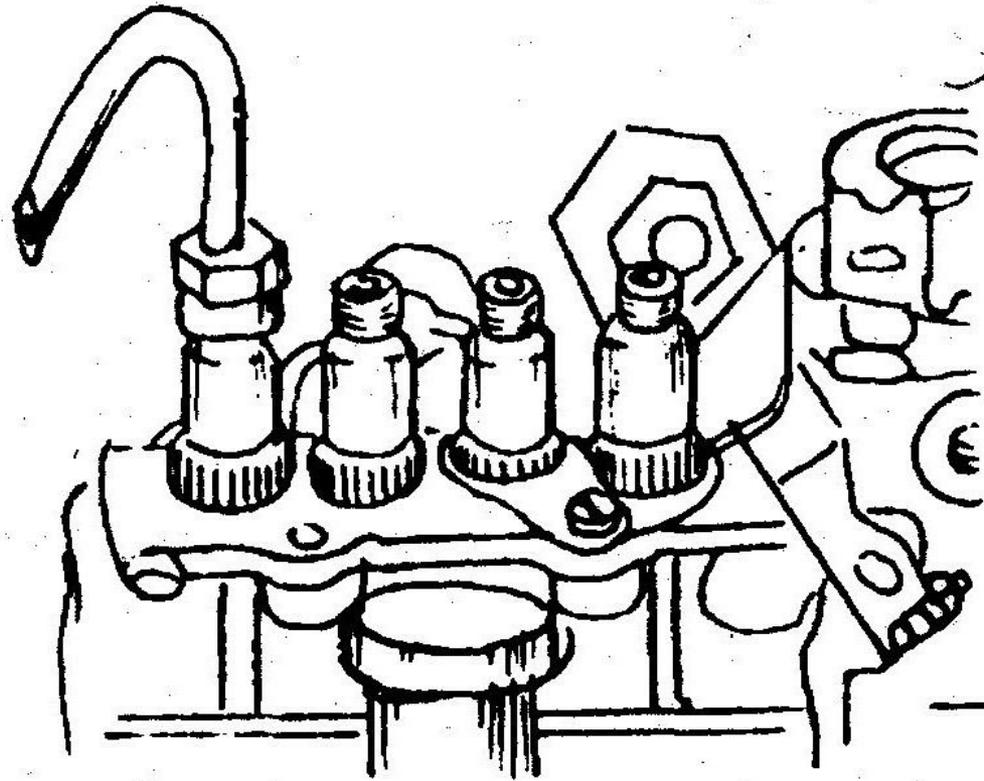
*Снимите трубопровод высокого давления, ведущий к первому цилиндру, и наденьте на штуцер трубку-моментоскоп*
