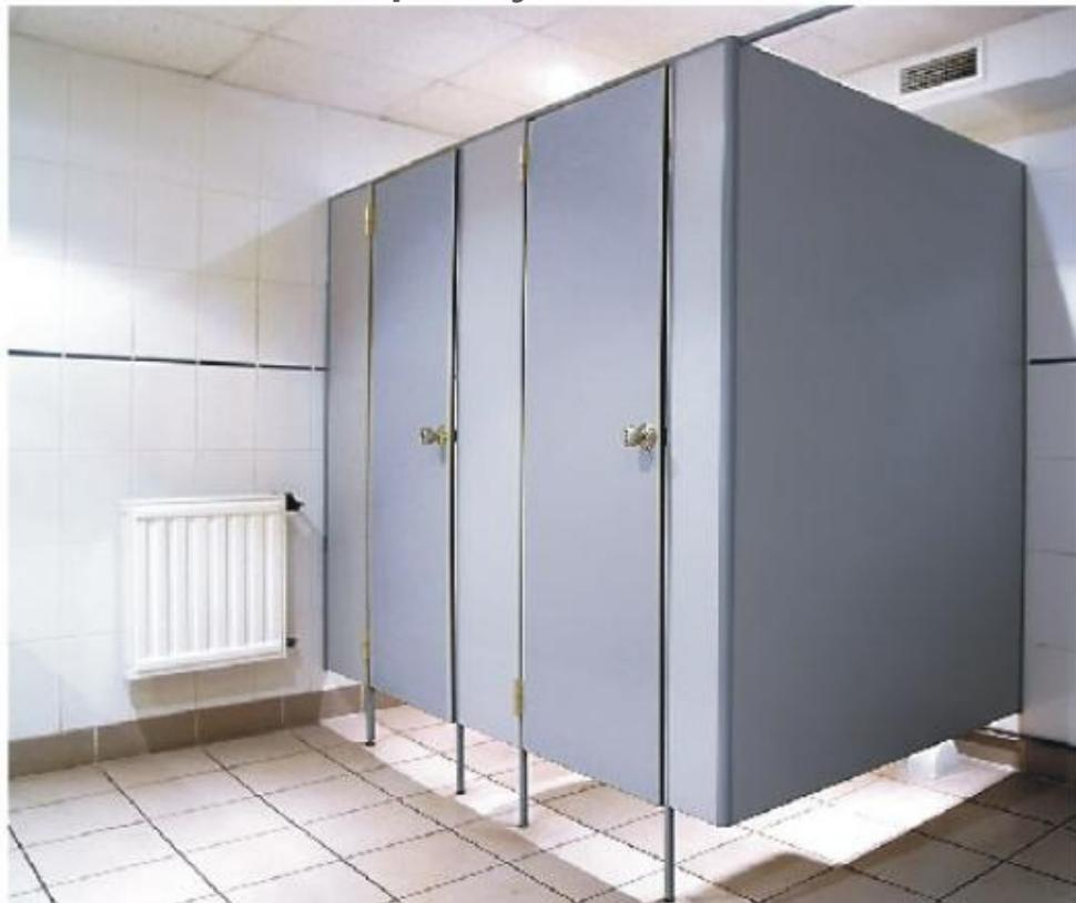
Точечная регулируемая опора компенсирует возможные неровности пола.
