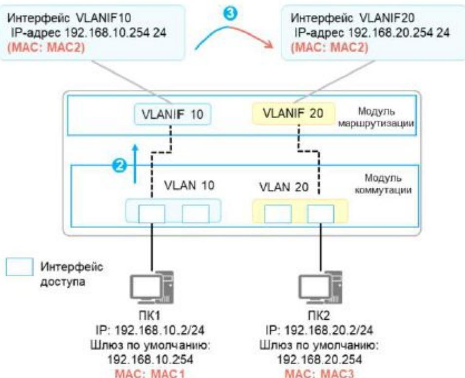
2. После получения пакета, отправленного с ПК1 на ПК2, коммутатор декапсулирует пакет и обнаруживает, что MAC-адрес назначения является MAC-адресом VLANIF10. Затем коммутатор отправляет пакет в модуль маршрутизации для дальнейшей обработки.
