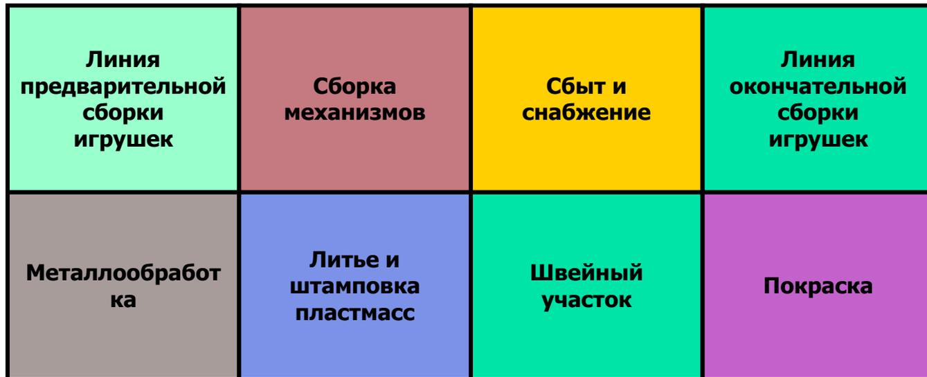
**Размещение оборудования по технологическому принципу**
