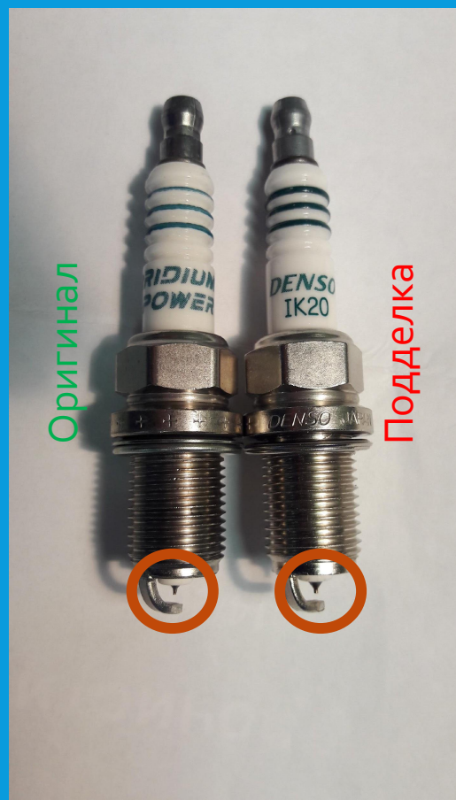
Разница в толщине электрода
