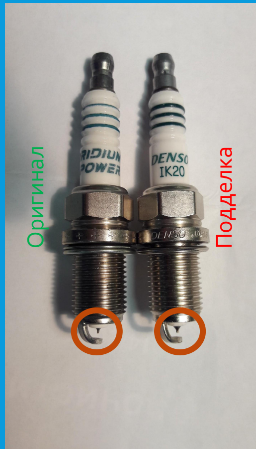
Разница в толщине электрода
