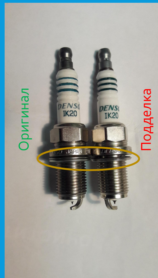
Разница в толщине уплотнительного кольца
