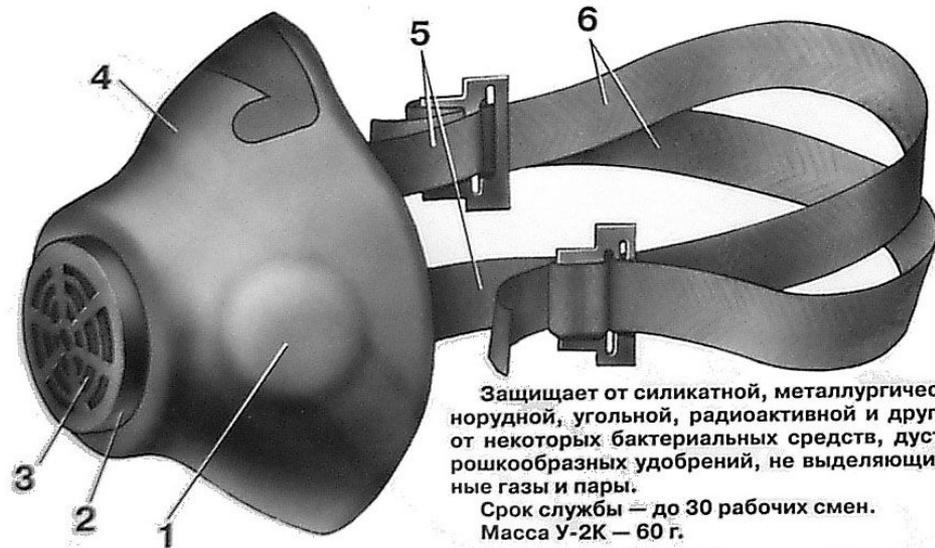
Защищает от силикатной, металлургической, горнорудной, угольной, радиоактивной и другой пыли, от некоторых бактериальных средств, дустов и порошкообразных удобрений, не выделяющих токсичные газы и пары.
