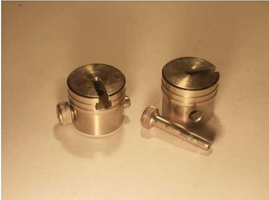
Захваты для испытания на растяжение
