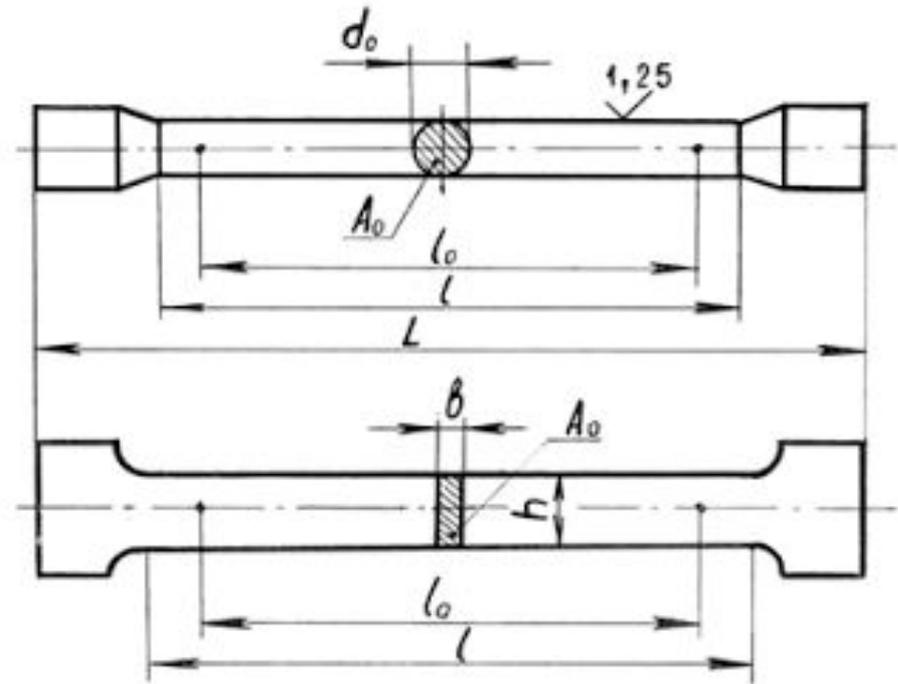
Образцы для испытания на растяжение
