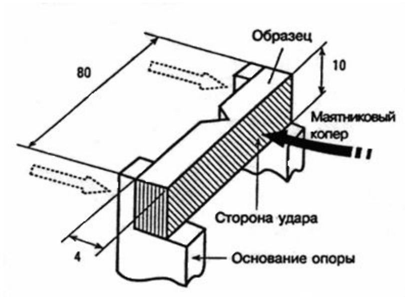
Метод измерения ударной прочности по Шарпи
