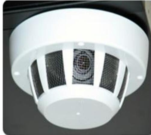
*Пожарный датчик со встроенной видеокамерой и микрофоном*
