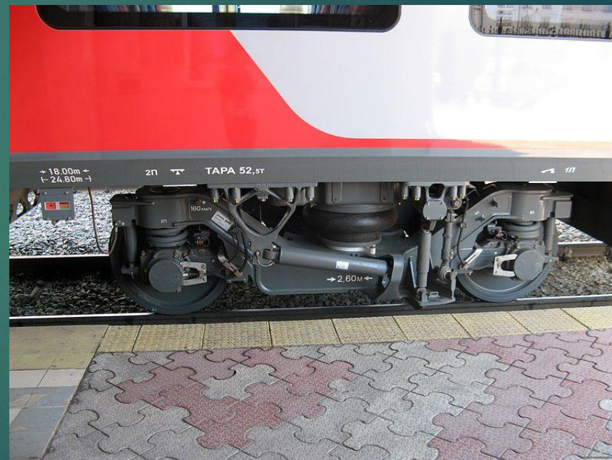
Безмоторная тележка промежуточного вагона ЭС1
