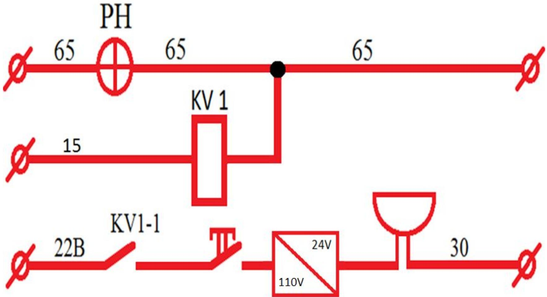
В качестве основного исполнительного органа применено реле РП 21(возможно применение любых реле разных производителей с напряжением катушки до 110в).
