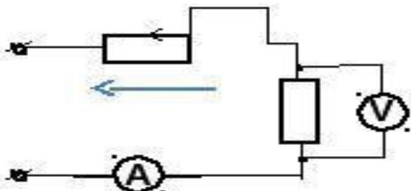
Изменятся ли показания амперметра и вольтметра, если ползунок реостата передвинуть в направлении стрелки?
