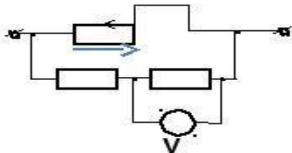
Будет ли изменяться и как показание вольтметра, если ползунок реостата перемещать в направлении, указанном стрелкой? Напряжение на зажимах цепи поддерживается постоянным.
