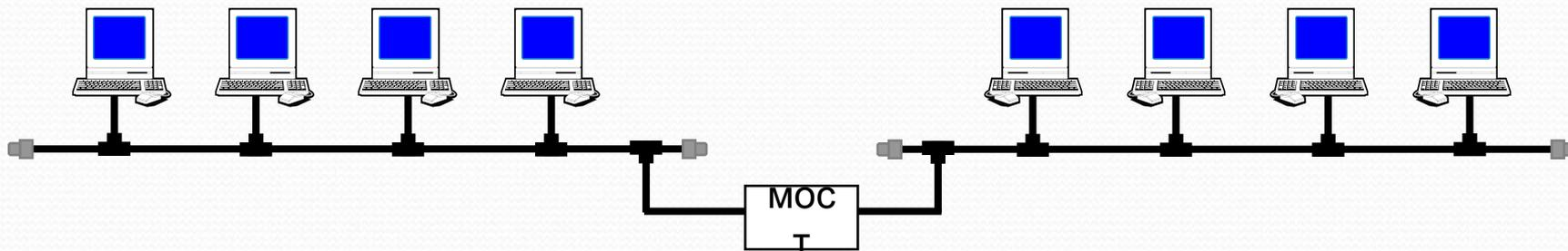
Вариант: компьютер с двумя сетевыми картами.
