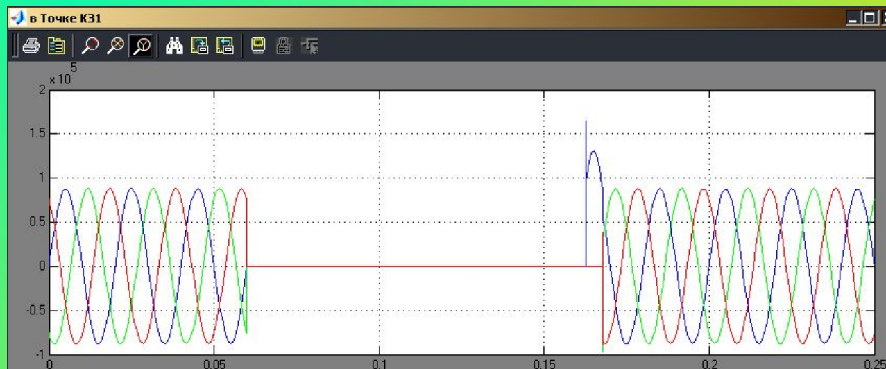
Оциллограммы напряжения при трёхфазном КЗ
