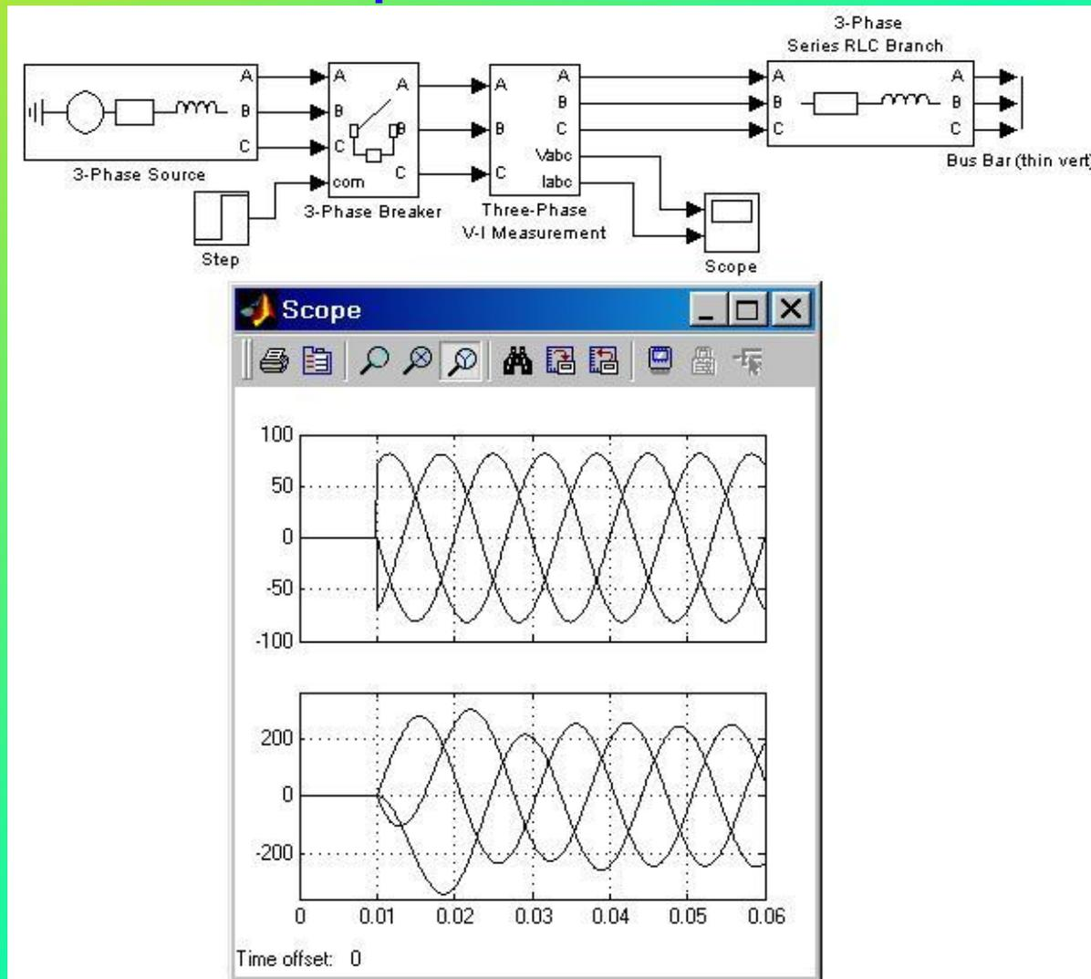
Схема подключения блока трёхфазного прибора для измерений
