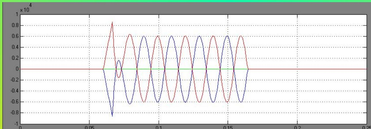
Оциллограммы токов при двухфазном КЗ
