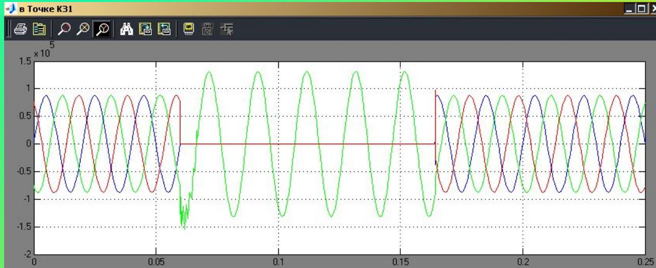
Оциллограммы напряжений при двухфазном КЗ
