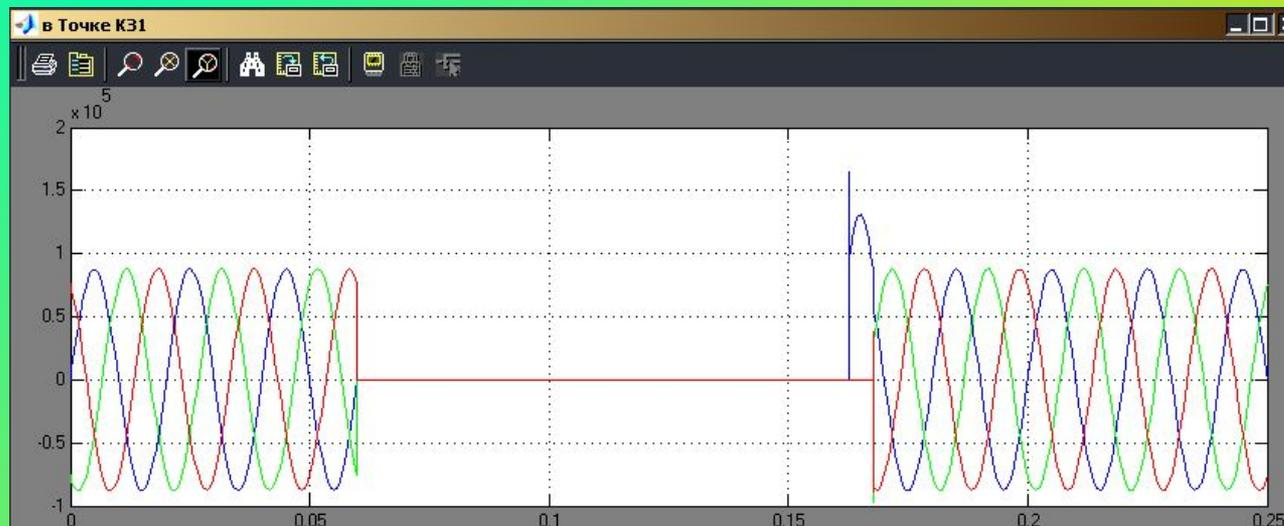
Осциллограммы напряжения при трёхфазном КЗ
