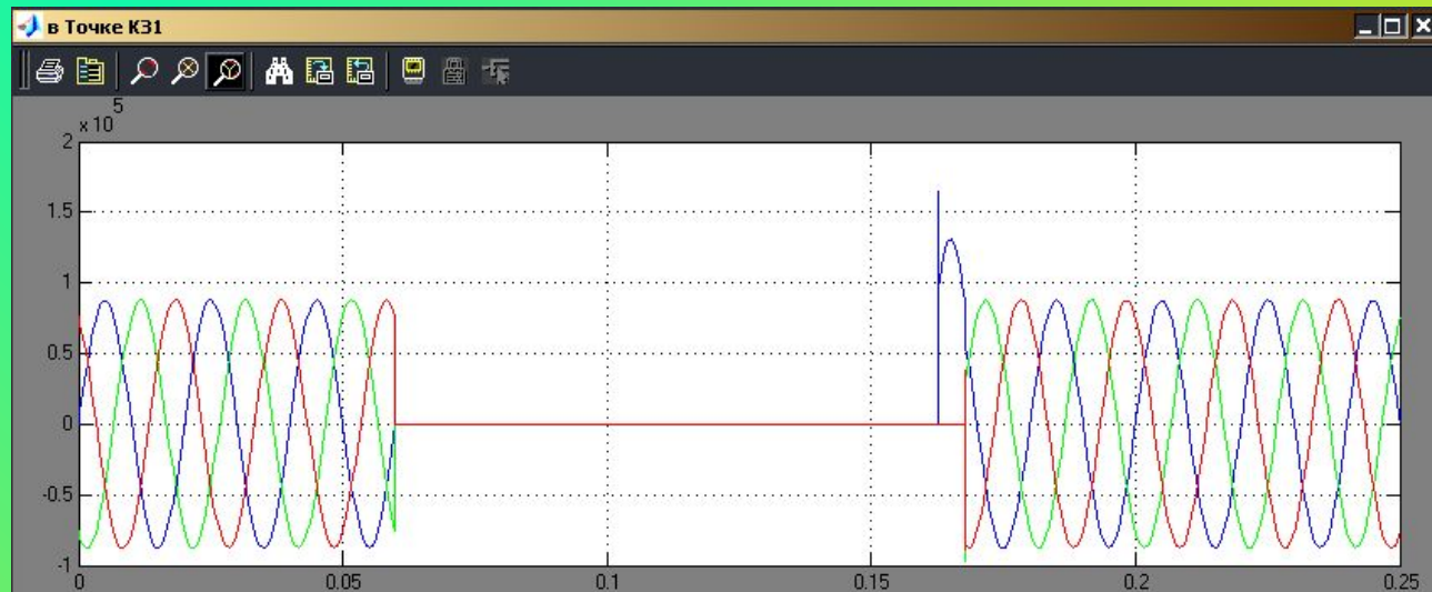
Оциллограммы напряжения при трёхфазном КЗ
