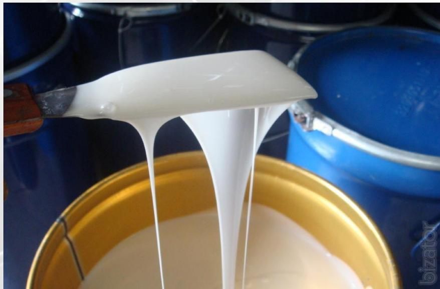
Высокая прочность связи  $-\text{Si}-\text{O}-$  делает ее устойчивой к воздействию теплоты и окислителей. Большая разница в электроотрицательности кремния и углерода придает подвижность –органическим радикалам и определяет повышенную гибкость полисилоксановых цепей
