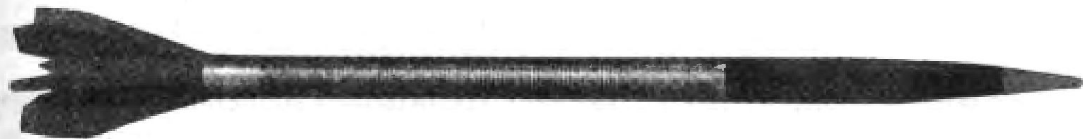
Рис. 8.21. 120-мм БОПС М829 (США) ( a ) с корпусом из обедненного урана ( б )
