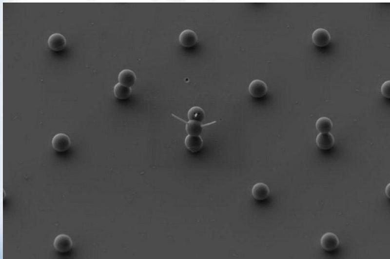
**Снеговик состоит из 3 сфер размером 0,9 микрон каждая, а рожица у него прорезана с помощью электронного пучка.**
