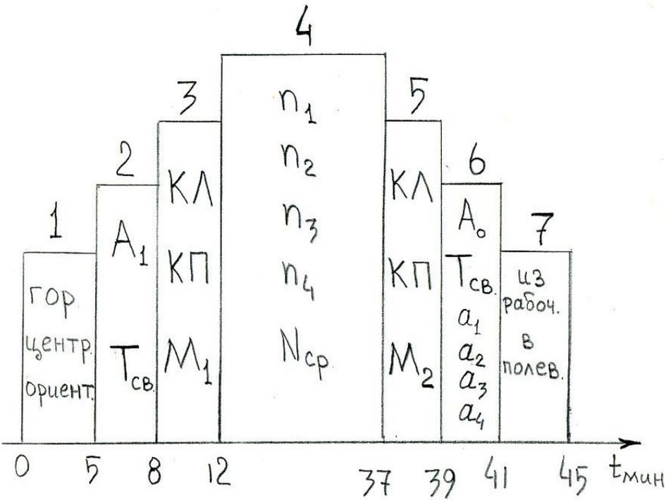
1. Подготовка гиротеодолита к работе: Горизонтирование, центрирование, ориентирование на север с точностью  $\approx 5^\circ$ , подключение источника питания  $U=12V \pm 1V$ .
