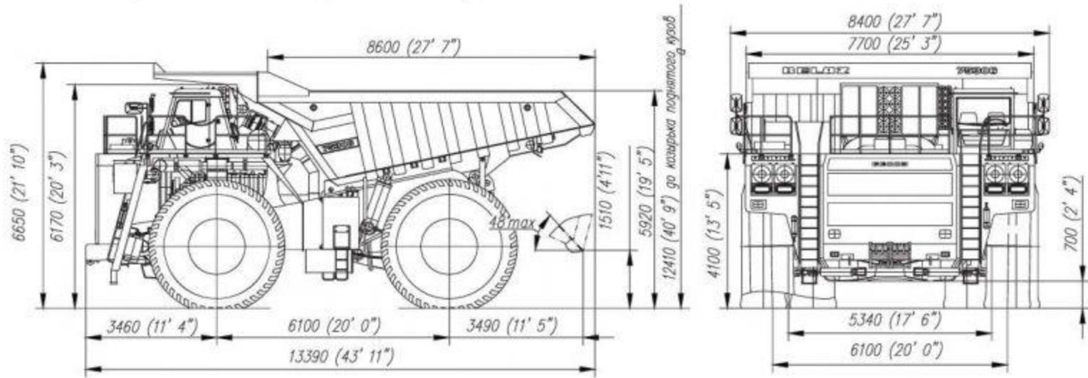
\* Габаритные размеры указаны для базовой комплектации самосвалов
