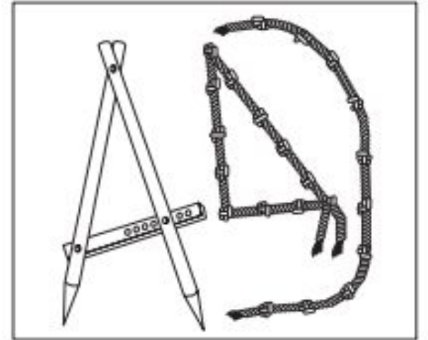
Рис. 1.8. Измерительные инструменты — циркуль и мерный шнур (по материалам книги С. К. Боголюбова)
