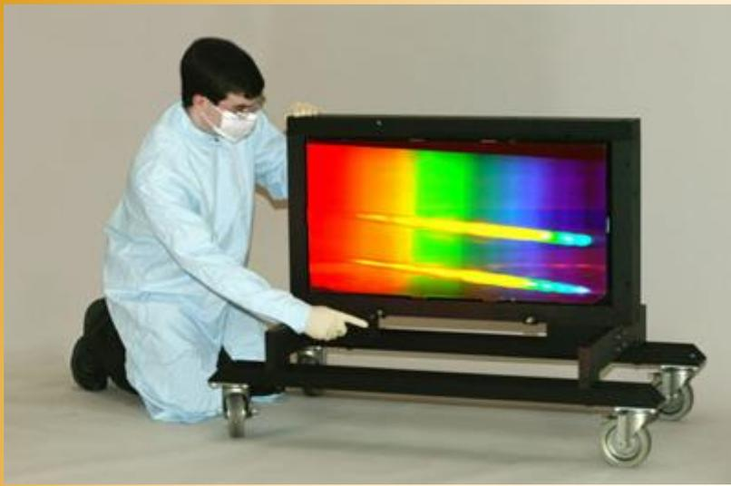
**Дифракционная решётка** — оптический прибор, действие которого основано на использовании явления дифракции света. Представляет собой совокупность большого числа регулярно расположенных штрихов (щелей, выступов), нанесённых на некоторую поверхность. Первое описание явления сделал Джеймс Грегори, который использовал в качестве решётки птичьи перья.
