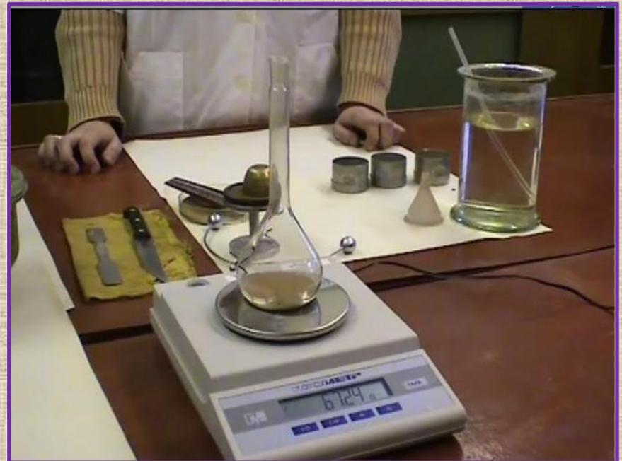
3. Добавление в пикнометр с грунтом воды на 1/3 высоты его широкой части и кипячение на песчаной бане, для удаления воздуха – 1 час.
