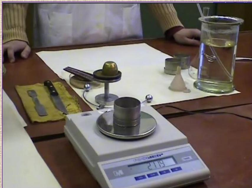
2. При достижении влажности на границе текучести балансирующий конус погружается в пасту грунта под действием собственного веса за 5 сек на глубину 10 мм.
