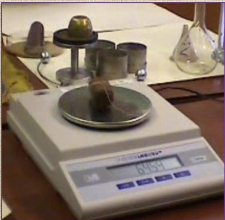
4. Перед взвешиванием на архимедовых весах образец грунта 3 раза опускается в кипящий парафин.
