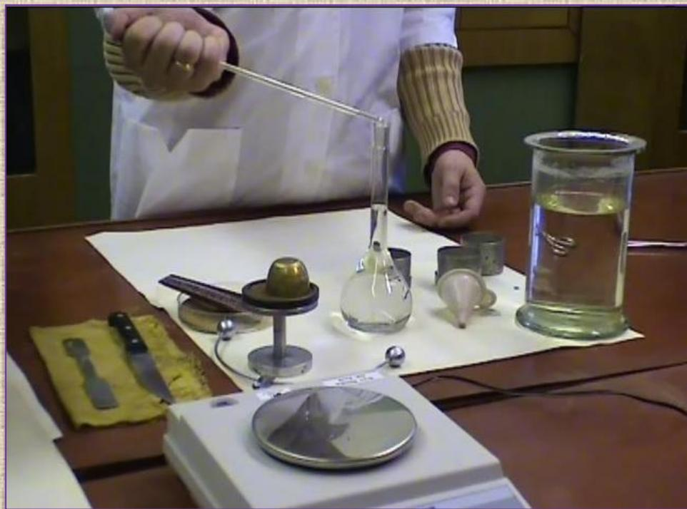
6. Определение массы пикнометра с дистиллированной водой, залитой до мерной риски,  $m_2$
