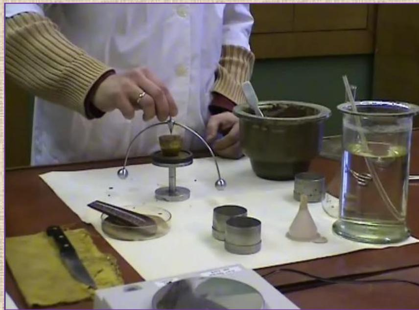
2. Определение массы стаканчика с пробой грунта и крышкой,  $m_2$
