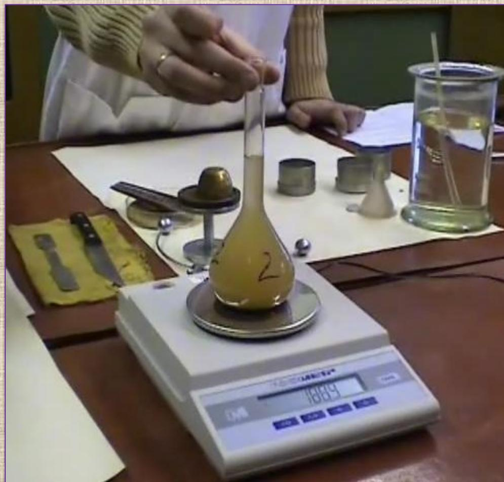
5. Наполнение пикнометра дистиллированной водой до мерной риски (последние капли добавляются стеклянной пипеткой).
