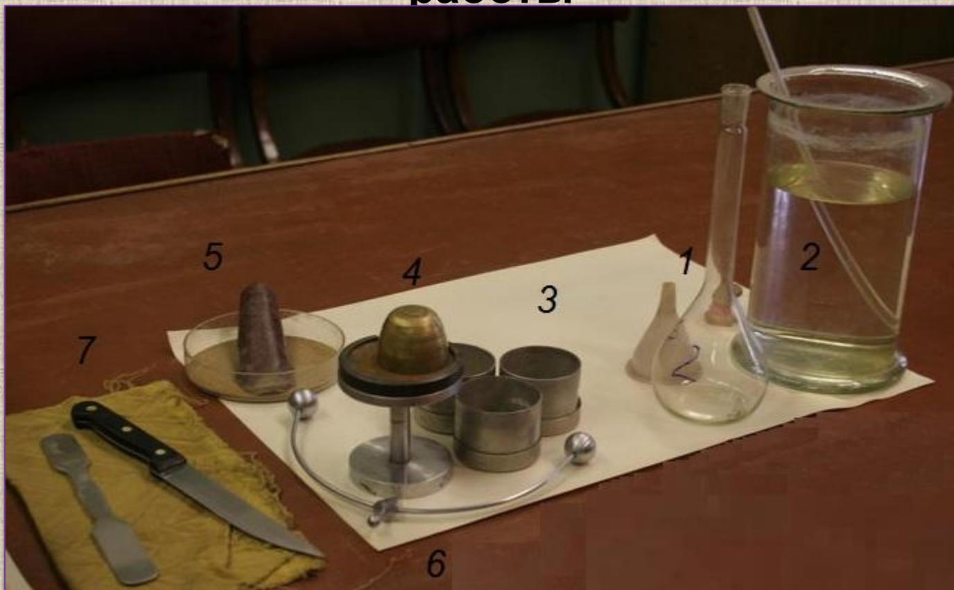
1. Пикнометр и воронка, с помощью которой в него засыпается грунт или наливается вода.
