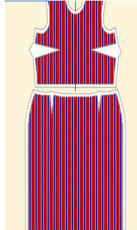
В моделях отрезных по линии талии, середина доминирующей полосы должна находиться на линии середины переда и спинки.
