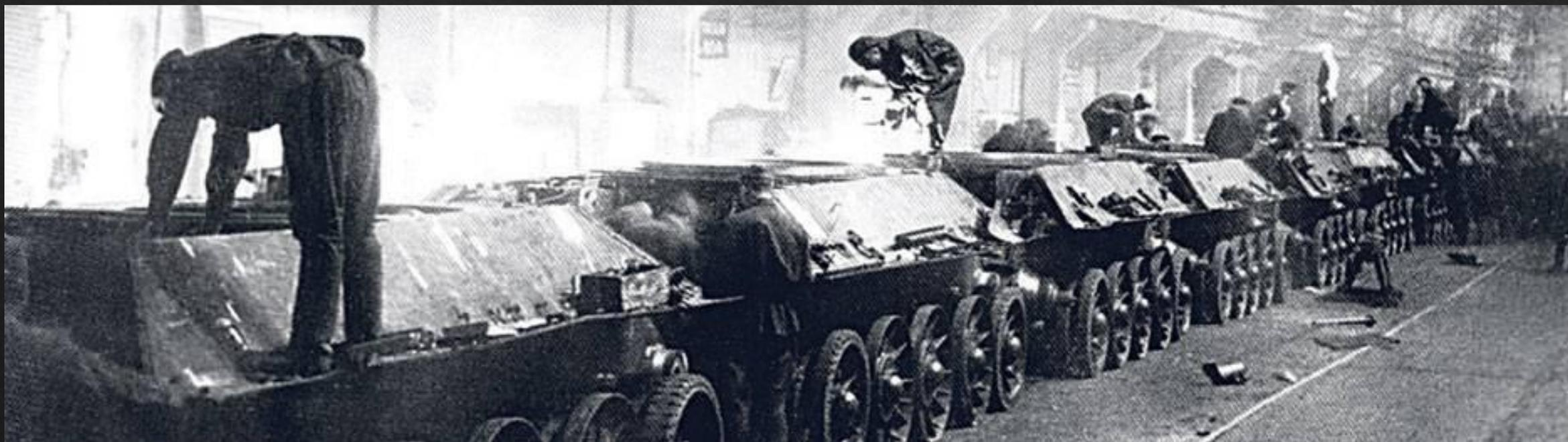
Выход был один - Автоматизировать процесс сварки бронекорпуса танка. С этой задачей блестяще справился эвакуированный на Урал и значительно поредевший коллектив Института электросварки. По 12-16 ч в сутки работали тогда патоновцы. И проблема была решена.
