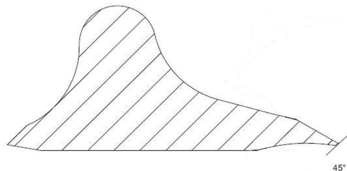
Необходимо провести заточку верхнего неподвижного ножа в отмеченной зоне (для предотвращения застревания ствола при протяжке назад)
