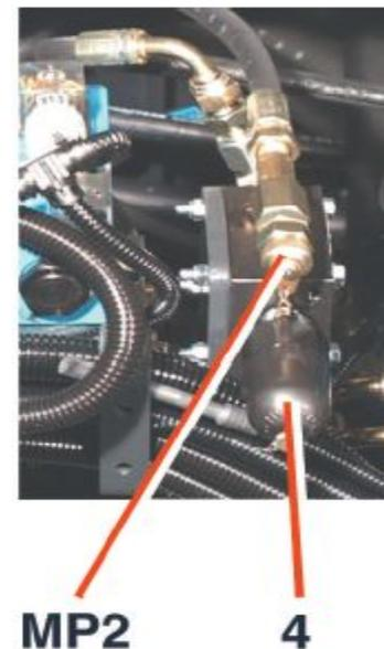
3- регулировка мин. На регуляторе насоса х\г
