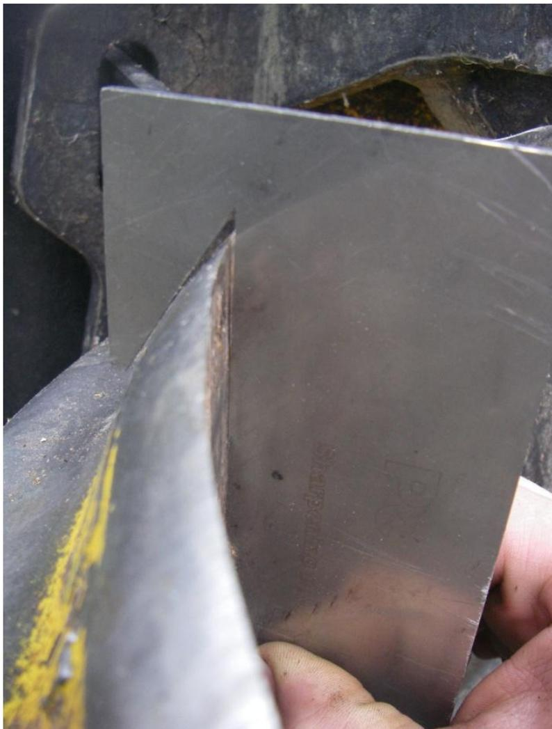
Литые сучкорезные ножи не должны быть заточены с нижней стороны! Если зазор слишком велик – используйте молоток для корректировки зазора!
