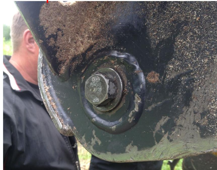
Устанавливаем верхнюю шайбу и закручиваем гайку с усилием 50Нм
