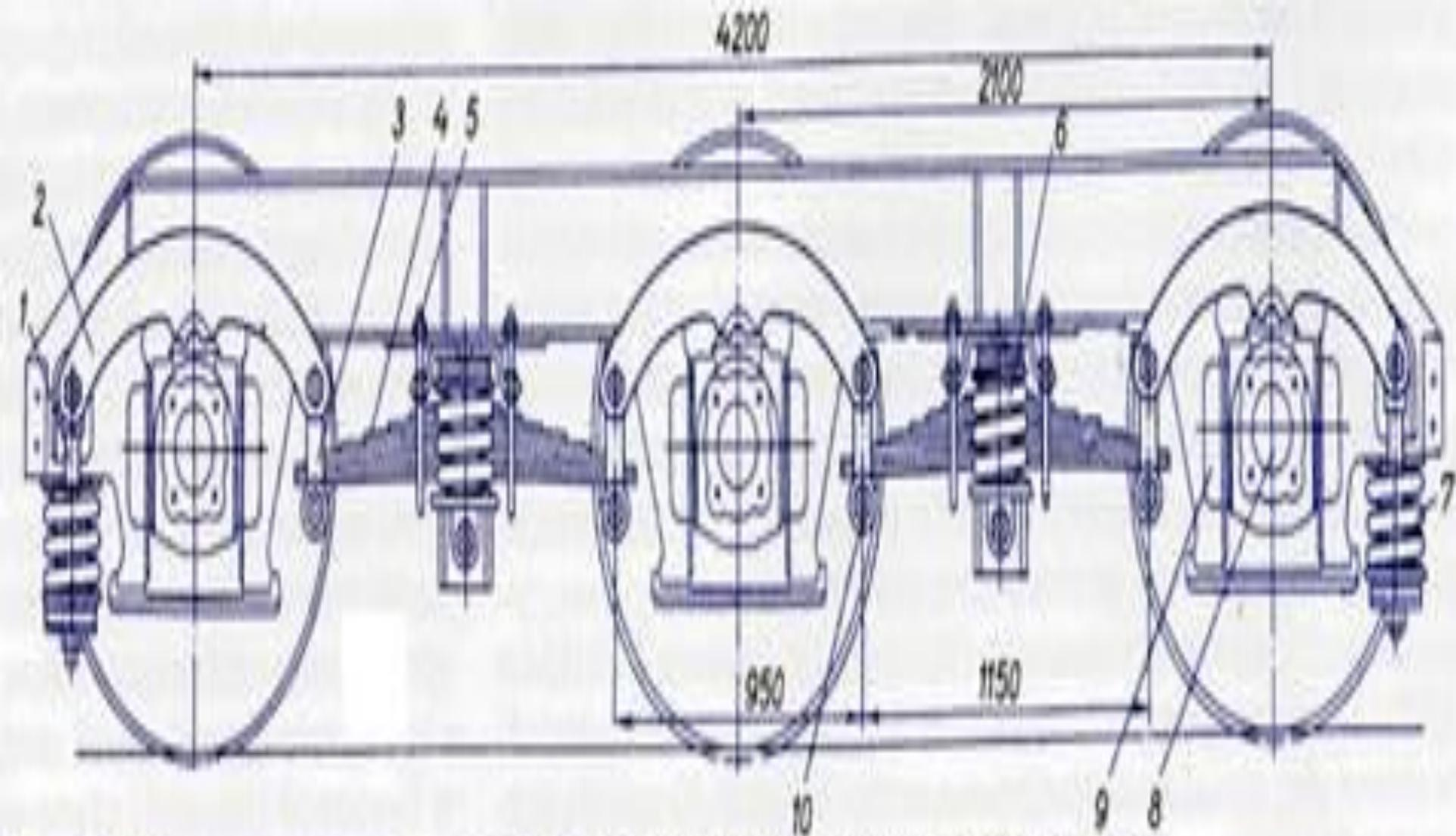
**Рис. 82 Сбалансированное рессорное подвешивание тележки тепловоза ТЭЗ:**
