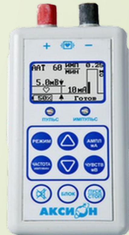
Переносной электрокардиостимулятор ЭКСН-1К
