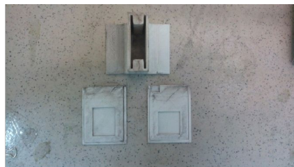
Рисунок 3 – Фото стакана, распечатанного на 3D-принтере: а) вид сбоку; б) вид сверху и держатели для электродов
