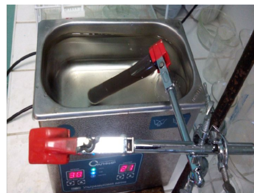
Рисунок 5 – Фото разбиения частиц компонентов суспензии при помощи ультразвука
