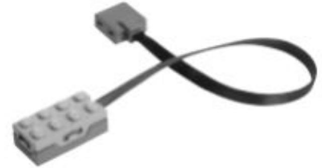
Датчик наклона сообщает о направлении наклона.
