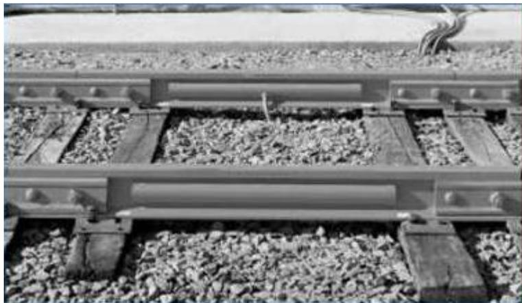
Весы "датчик-рельс" представляют собой переоборудованный в двухпорный датчик силы участок железнодорожного рельса. Такие весы были сконструированы сотрудником компании Weightronix - Джеком Калдикоттом (Jack Caldicott) и установлены на медных рудниках Чили
