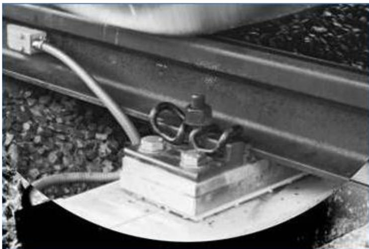
Первые конструкторские разработки таких весов появились ещё в 60-х годах 20 века, однако широкое применение нашли лишь сравнительно недавно - в начале 21 века. Весы "датчик-шпала" представляют собой устройство взвешивания, не имеющее грузоприемной платформы.
