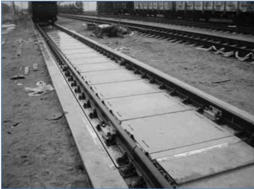
Платформенные или мостовые тензометрические вагонные весы – это прямые «наследники» механических рычажных весов. Конструкция весов, грубо говоря, представляет собой тензометрические датчики, на которые устанавливается грузоприемная платформа - "мост".
