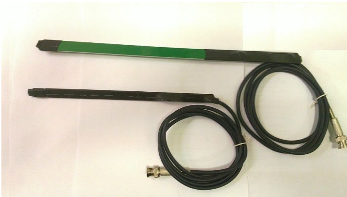
Набор датчиков-линеек (идук. + ёмкост) для экспресс-диагностики
