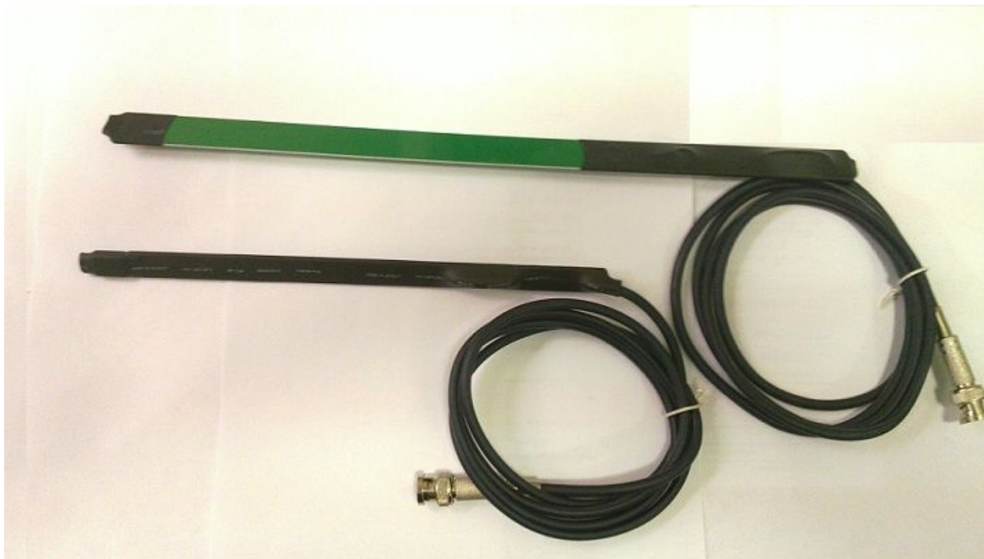
Набор датчиков-линеек (идук. + ёмкост) для экспресс-диагностики
