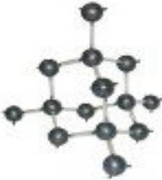
**Атомными** называют кристаллические решётки, в узлах которых находятся отдельные атомы, которые соединены очень прочными ковалентными связями.
