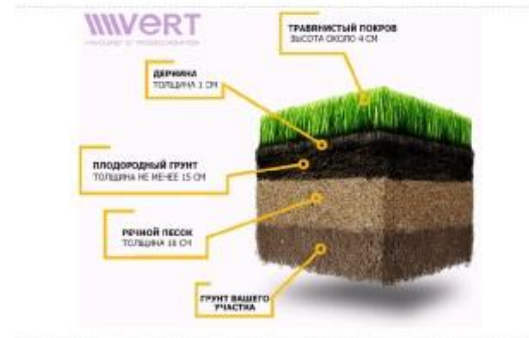
Устройство газона, клумбы
