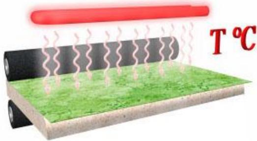
В качестве нагревательных элементов применены ТЭНы с корпусом из нержавеющей стали, эксклюзивные особенности которых обеспечивают равномерный прогрев заготовки, достаточно высокую скорость обработки материала, минимальное количество бракованной продукции, что гарантирует достойную эффективность производства .
