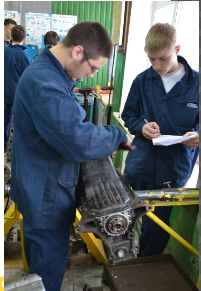
Размыслов Данил выполняет операции по разборке, дефектовки и сборки ДВС TOYOTA 3A
