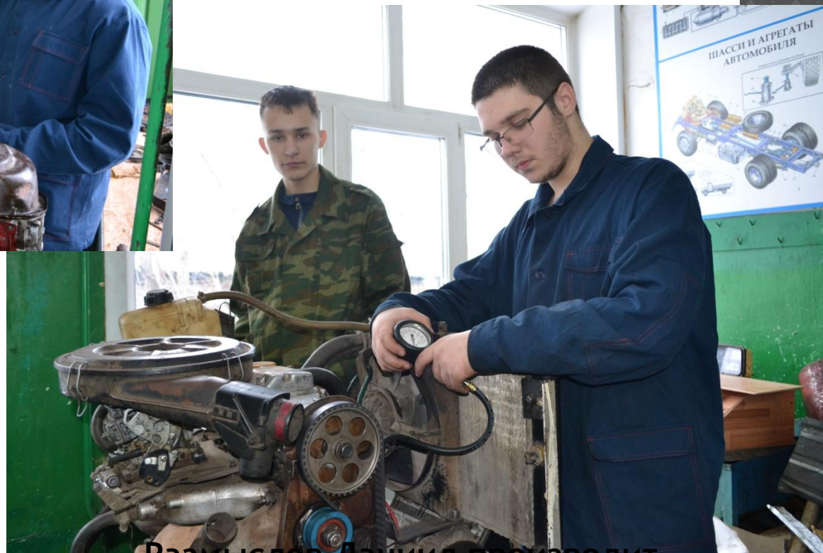
Размыслов Даниил производит проверку компрессии ЦПГ.
